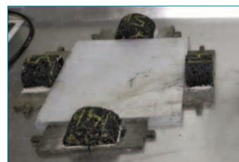
Foto 6: Sistema de pegado de las probetas
