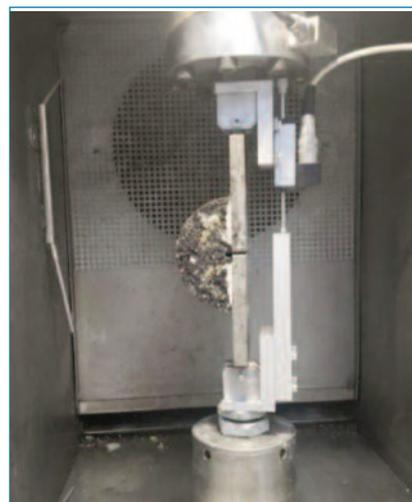
Foto 7: Sistema de sujeción en la prensa de ensayos
