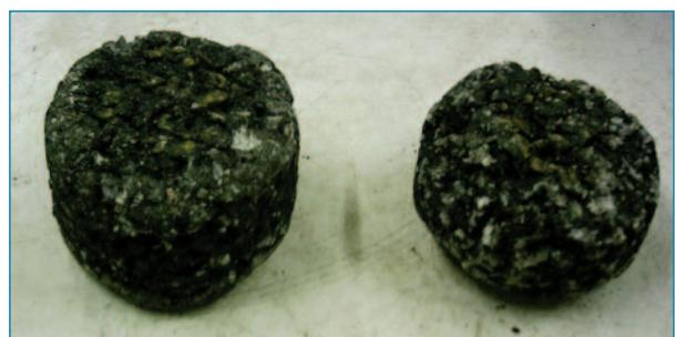
El ensayo de las probetas se realiza introduciendo cada una de las probetas en la máquina de Los Ángeles y aplicando 300 vueltas para las probetas de mezclas en caliente y 200 vueltas para las probetas de mezclas en frío. Al finalizar se limpia cada probeta y se calcula su pérdida.
