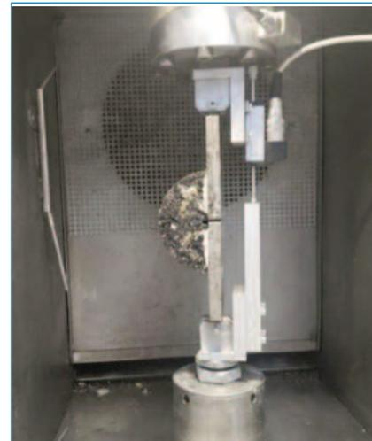
Foto 7: Sistema de sujeción en la prensa de ensayos
