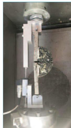
Foto 4: Sistema de medida de la deformación
