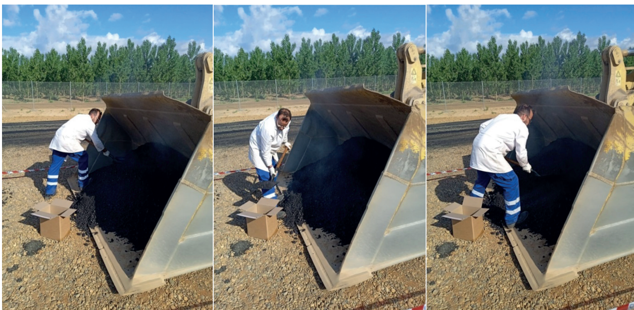
Figura 8. Toma de muestra sobre el cazo de una pala cargadora.
