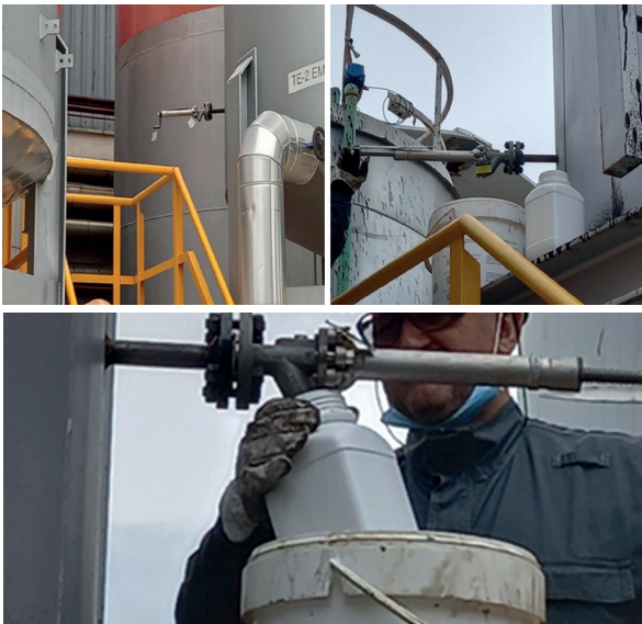
Figura 13. Toma de muestra de emulsiones bituminosas
