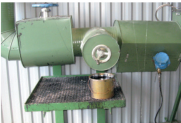
Figura 2. Toma de muestra de betún en las instalaciones de fabricación
