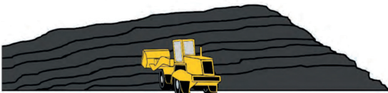
Figura 6. Disposición de los materiales recepcionados en estratos.
