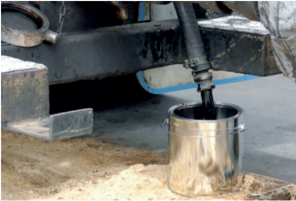
Figura 1. Toma de muestra de betún durante la descarga en planta
