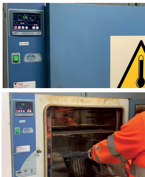
Figura 15. Acondicionamiento de muestras en estufa.
