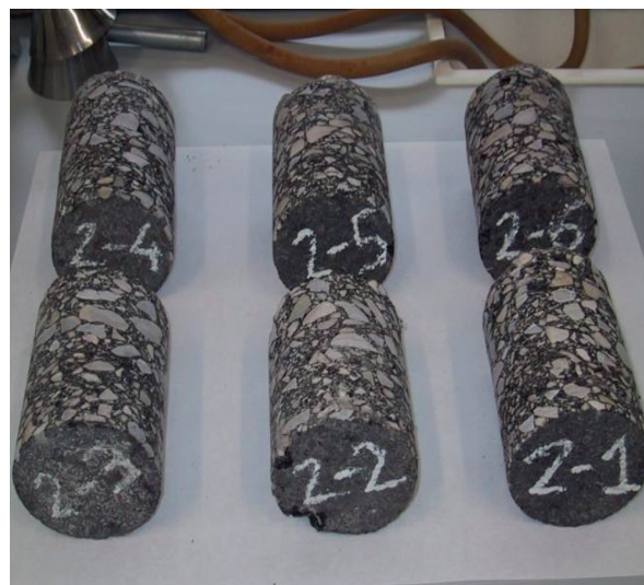
Figura 11. Muestras testigo de pavimento bituminoso.
