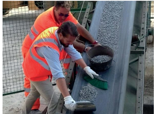
Figura 4. Toma de muestra de áridos en cinta transportadora.
