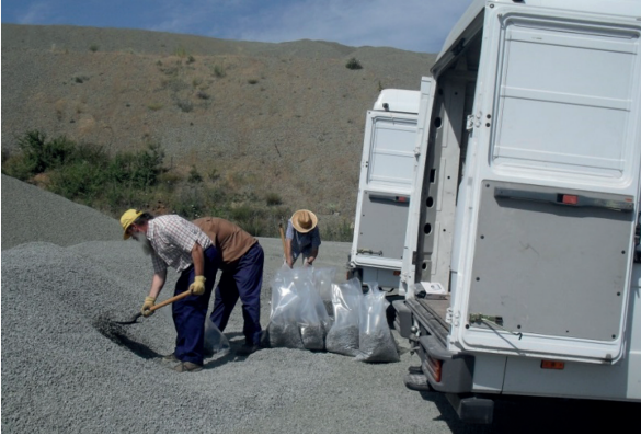
Figura 3. Toma de muestra de áridos en acopio.
