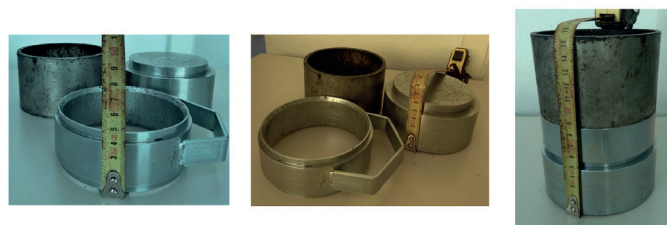
Foto 2. Propuesta 2 - Molde y base especiales (collarín estándar UNE-EN 12697-30) para compactación de probetas de 3 cm por ambas caras.
