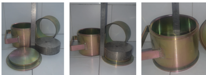
Foto 1. Propuesta 1 - Molde, base y collarín estándar (UNE-EN 12697-30) para compactación por impactos, junto con el disco espaciador utilizado.
