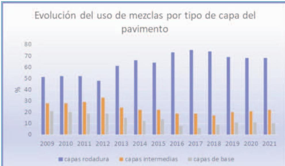
En 2013, coincidiendo con el mínimo de producción de mezclas bituminosas en España, se produjo un cambio brusco en el porcentaje de mezclas destinadas a capas de rodadura. Este cambio se debió a que el mercado quedó reducido a obras de rehabilitación, desapareciendo gran parte de las obras de construcción de nuevas carreteras en las que los porcentajes
