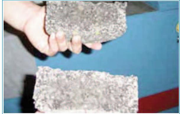
Foto 4. Probeta rota a tracción indirecta.
