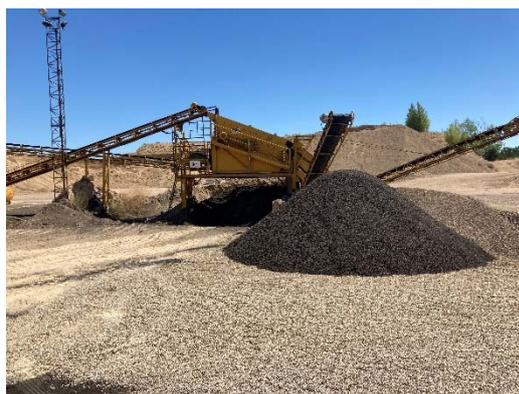
*Foto 14. Detalle de la máquina clasificadora de materiales*
