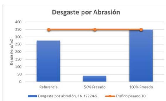
Gráficos 1, 2. Cohesión y Desgaste por abrasión de los microaglomerados en frío.
