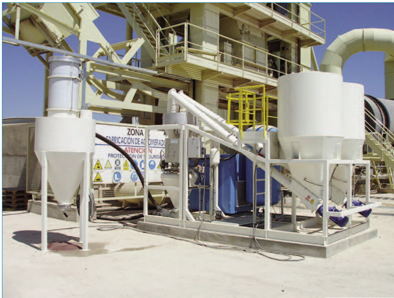
Figura 2: Dosificador aditivos (Fuente: SOTECMA)
