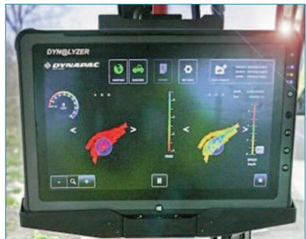
Figura 6. Pantalla con las pasadas y temperaturas superficiales
