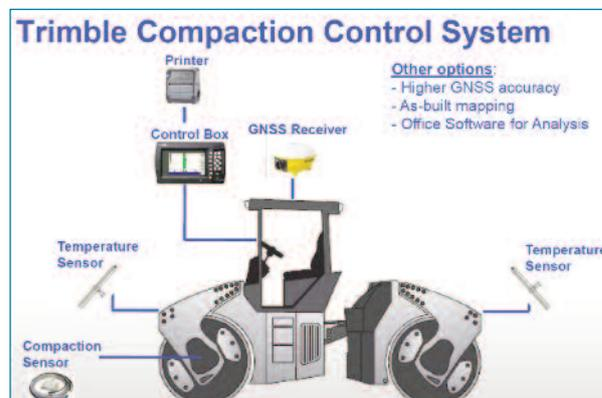
Figura 12. Esquema del sistema de IC de Trimble.
