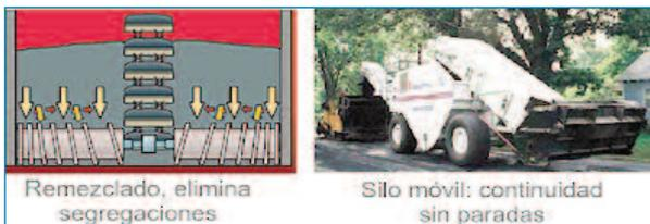
Figura 54. Silo móvil remezclador de transferencia de mezcla. (DRM) ROADTEC .
