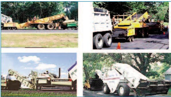
Figura 53. Equipos de transferencia de mezcla (DTM).
