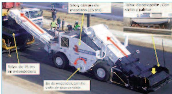
Figura 58. DRM, silo móvil (Roadtec).
