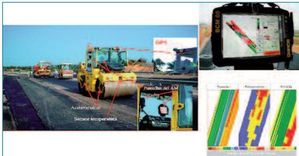
Figura 47. Compactación Inteligente- Asphalt Manager. Bomag.
