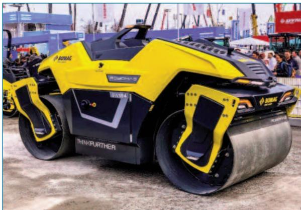
Figura 50. Compactador autónomo ROBOMAG BW154.
