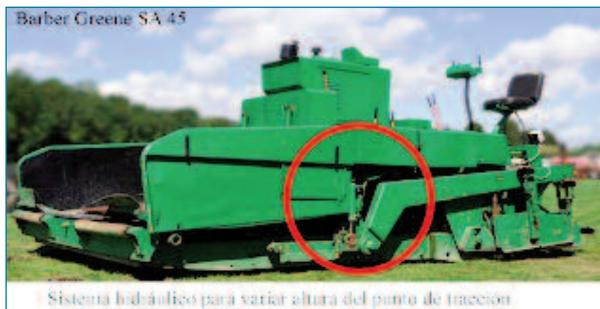
Figura 18. Sistema de nivelación automática.
