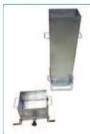
Conducto de llenado y cajón de descarga.
