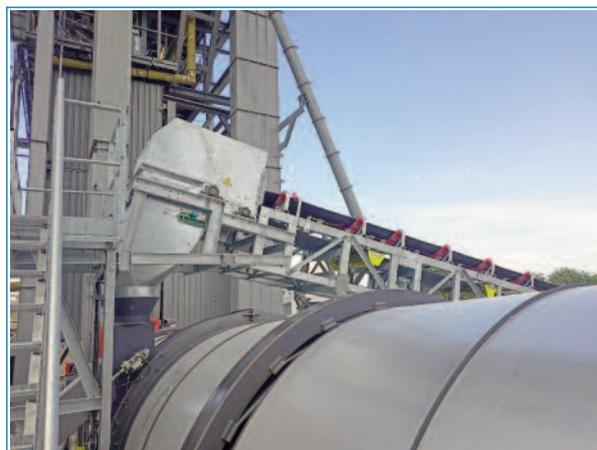
Imagen 10 Sistema de incorporación de material fresado al quemador.
