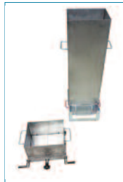
Conducto de llenado y cajón de descarga.
