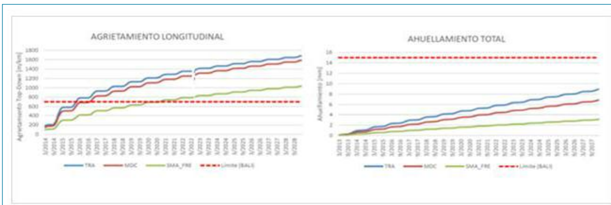
Figura 1. Agrietamiento y Ahuellamiento pronosticado [5]
