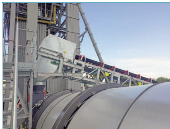
Imagen 10 Sistema de incorporación de material fresado al quemador.
