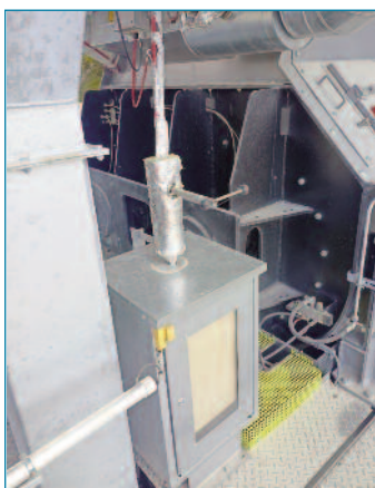
Imagen 12 Armario toma de muestras del sistema de espumación del betún.
