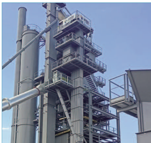
Imagen 11 Sistema de incorporación de fresado al mezclador.
