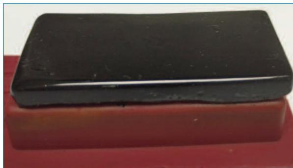
Figura 3. Superficie de betún asfáltico antes de ser sometido al proceso de oxidación a intemperie.
