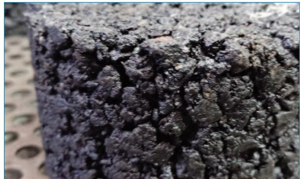
Foto de una probeta de mezcla bituminosa en frío.
