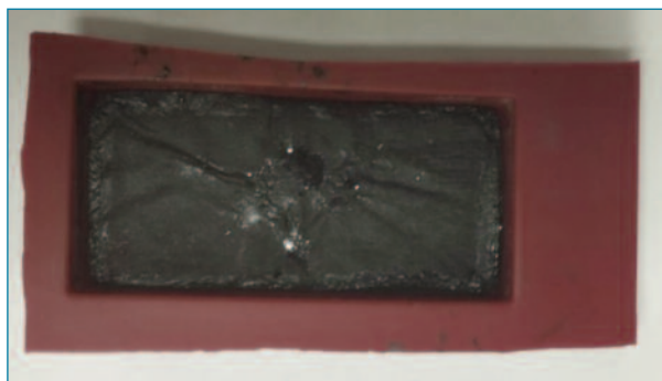
Figura 2. Moldes utilizados para la exposición de muestras de betún asfáltico a intemperie.
