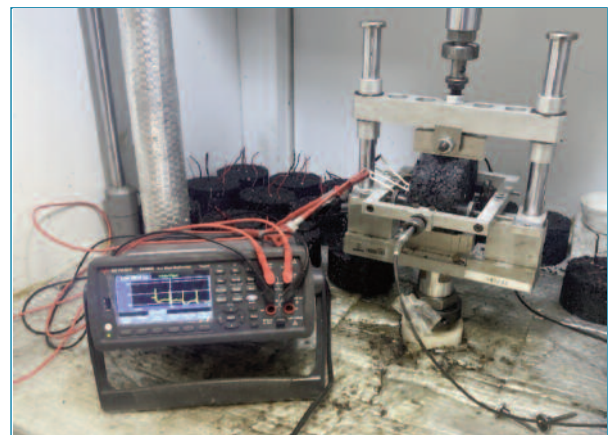
Figura 3. Ensayo de auto-detección de deformación
