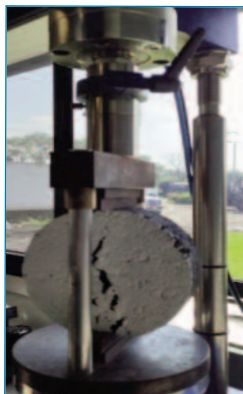
Figura 6. A) ensayo ideal cracking b) curva carga – desplazamiento
