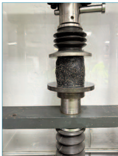
Imagen 2. Rotura a compresión simple.
