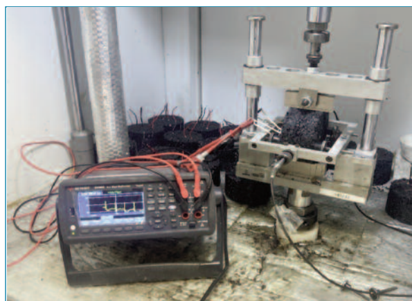
Figura 3. Ensayo de auto-detección de deformación
