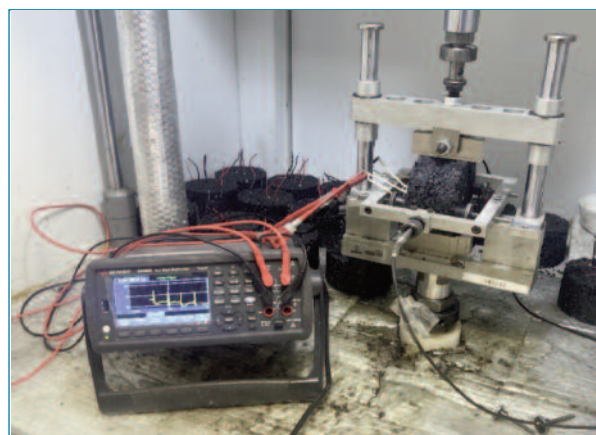
Figura 3. Ensayo de auto-detección de deformación
