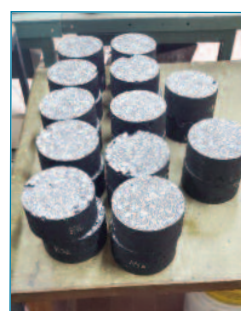
Figura 3. Probetas elaboradas de ambas mezclas asfálticas
