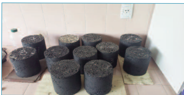
Figura 3. Probetas elaboradas de ambas mezclas asfálticas
