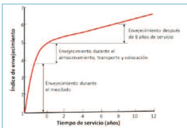
Figura 1. Etapas del proceso de envejecimiento de una mezcla bituminosa. Fuente: Cuadernos Tecnológicos de la PTC N°5/2015 [3]
