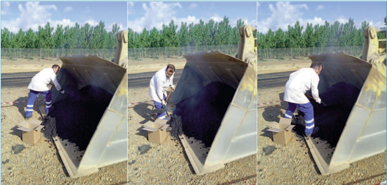
Imagen 5. Toma de muestras de mezclas bituminosas en caliente.
