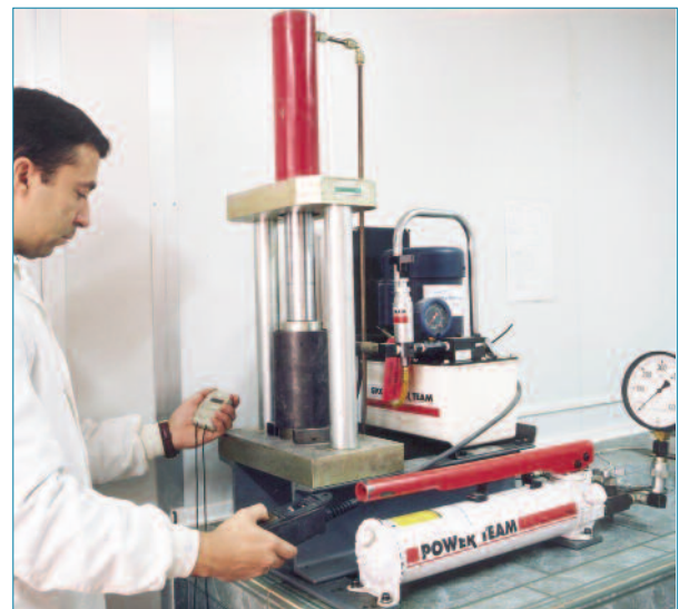
Imagen 3. Compactación de probetas de Inmersión-compresión.
