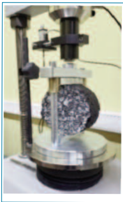
Figura 4: (a) Dispositivo de ensayo; (b) Curva típica P-l del ensayo IDEAL-CT
