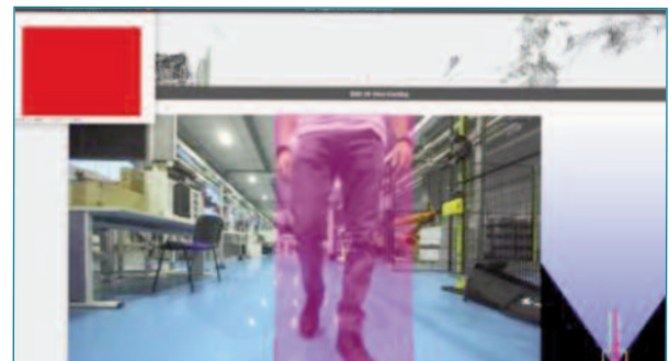
Figura 9: Cambio de la evaluación de riesgo de atropello según aproximación
