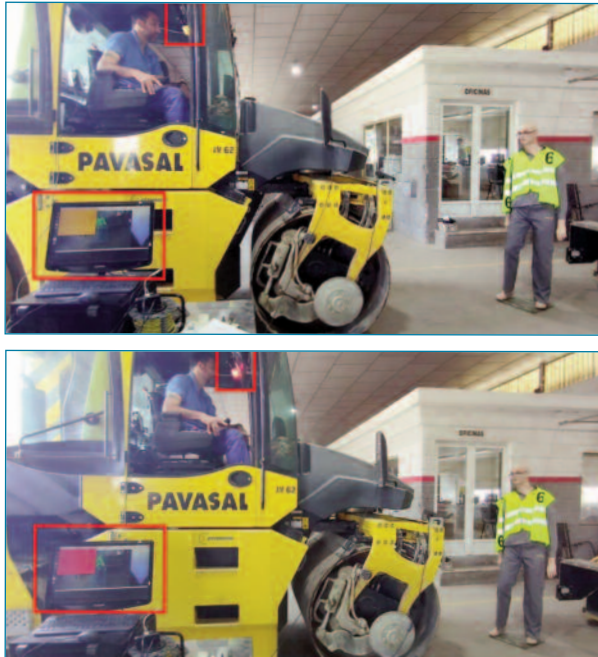
Figura 15: Alarmas riesgo medio y alto, con detención de máquina
