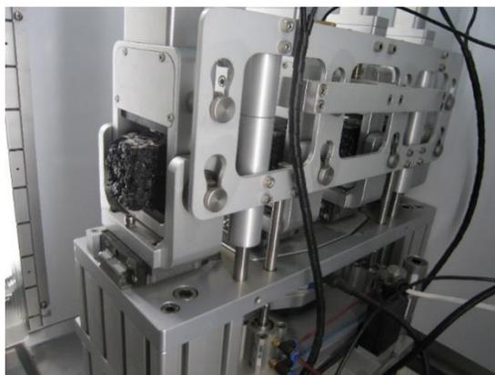
Imagen 2: Ensayo de fatiga a 4 puntos.
