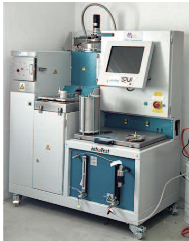
Imagen 1. Equipo de análisis de contenido de ligante con disolventes según la norma UNE EN 12697-1.
