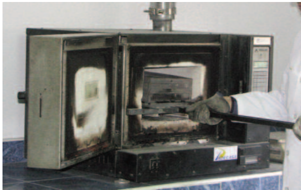
Imagen 2. Equipo de contenido de ligante por ignición UNE EN 12697-39.
