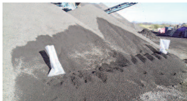
Imagen 3. Muestreo de acopios de los materiales fresados en planta.
