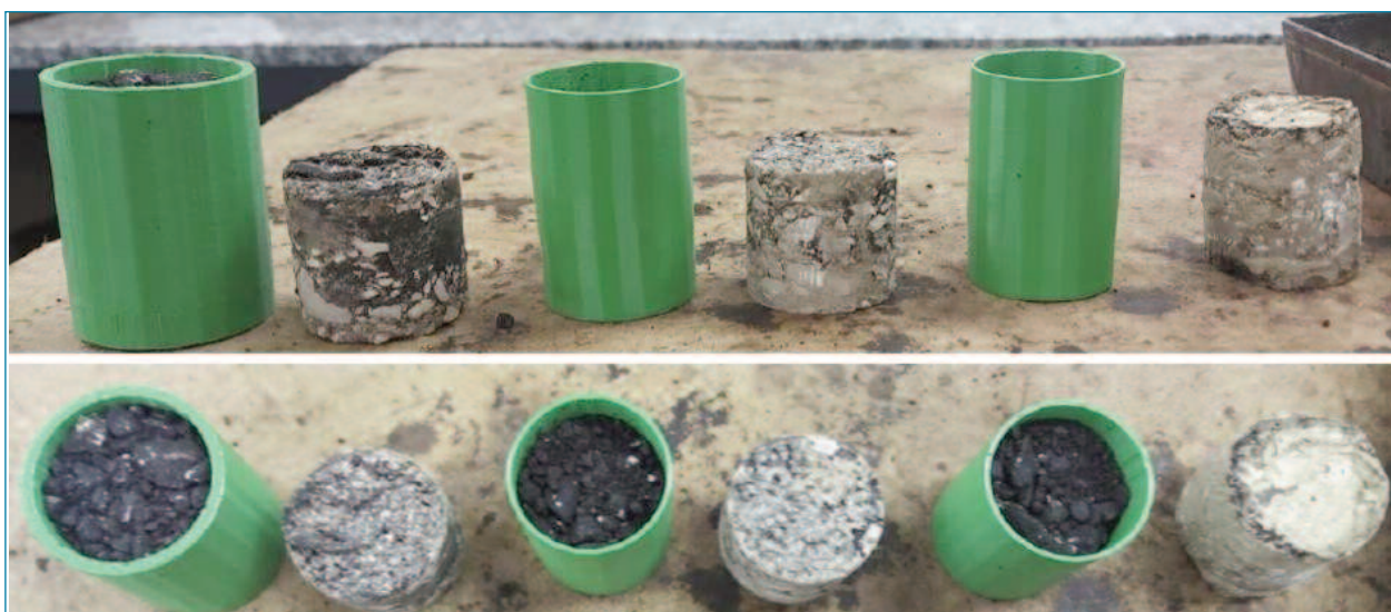
Figura 13. Preparación de muestras de asfalto para el análisis de tomografía de rayos X
