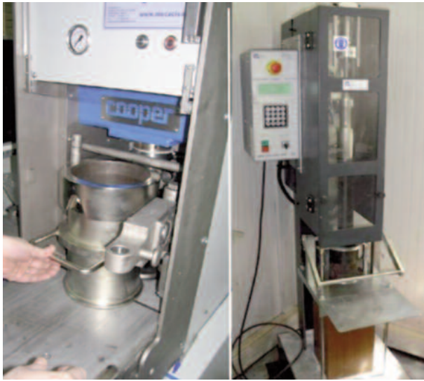
Imagen 1: Compactadora giratoria vs compactadora de impacto.
