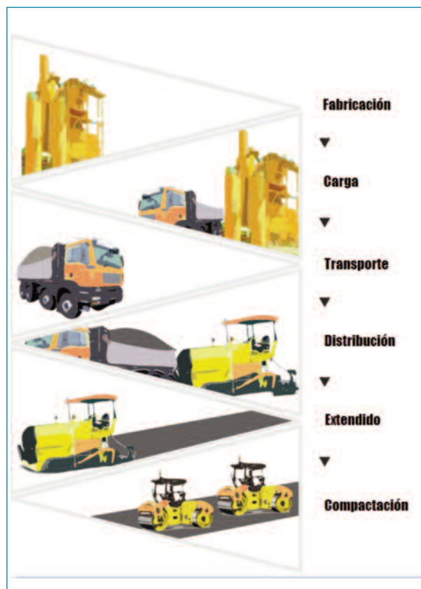
Figura 2. Diagrama proceso producción, transporte y ejecución de mezclas asfálticas.
